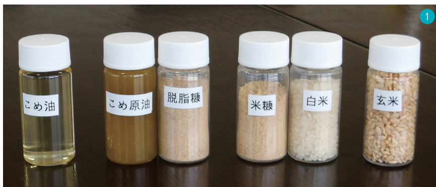
①こめ油の製造プロセス、玄米⑥が精米工程で白米と米糠に分かれ、その米糠からこめ原油と脱脂糠が抽出、こめ原油から製品としてのこめ油が精製される
