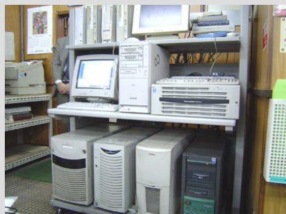
サーバー群(上段がFAX送信用、中段が受信用、下段右がDBサーバー)
