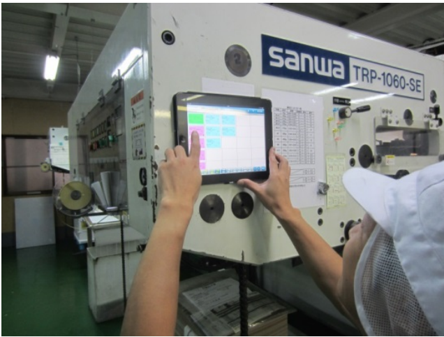
トムソン(打抜き)機付近でiPadから生産実績を入力している。場所を選ばず、すぐに入力できる。
