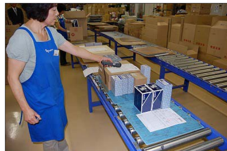
写真6: ハンディターミナルで出荷指図書のバーコードを読み出荷情報を表示。次いで各商品のバーコードを読み照合。
