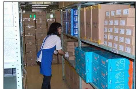
写真4: 出荷指図書に印字された品目コードでロケーションを探してピッキング。
