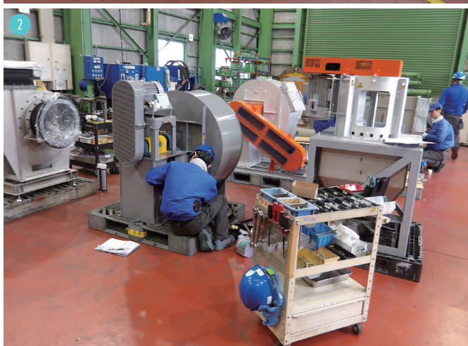
① 工場内で生産される各種製品 ② 完成品は実稼働テストを行って出荷される ③ 人の身長よりも大きな荷姿になる製品もある
