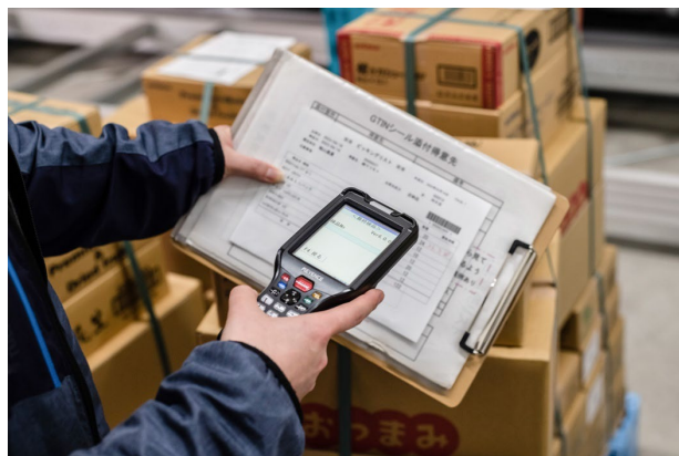
ピッキングリストに印字されたバーコードをスキャンし、ピッキング作業を開始する
