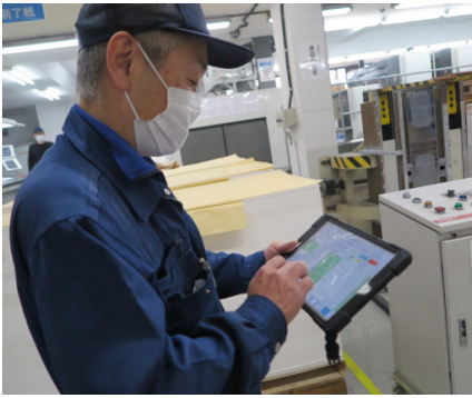
タブレット端末を使用し、現場で生産予定の確認や稼働実績を入力
