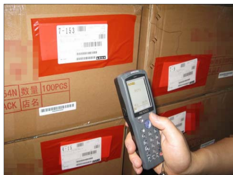
バーコード検品中の様子。誤出荷が1/10に。
